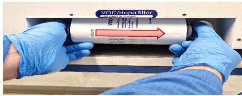
Εικόνα 12.2 Διαδικασία εισαγωγής και αφαίρεσης φίλτρου VOC/HEPA
