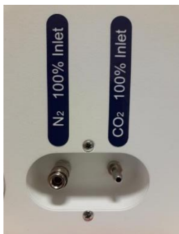
Εικόνα 11.1 Είσοδοι αερίου στο πίσω μέρος των επωαστήρων εξωσωματικής γονιμοποίησης Mini MIRI® Dry και Mini MIRI® Humidity
